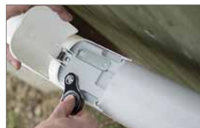
Możliwość wysprzężenia siłownika za pomocą pilota
