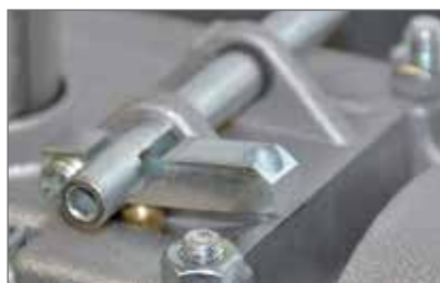
Zewnętrzne wysprzęglenie dla ręcznego odblokowania
