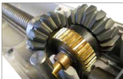
Solidna metalowa przekładnia (RAY40)
