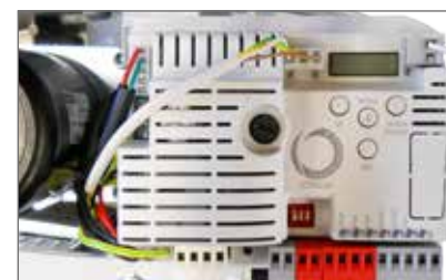
Centrala sterująca CT102 24 z wbudowanym odbiornikiem radiowym
